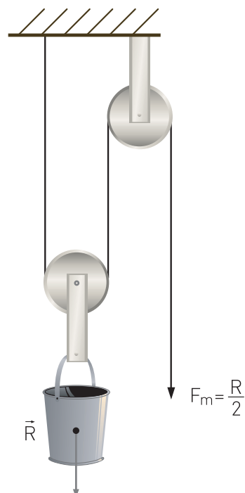
Combinación de polea fija y móvil.
